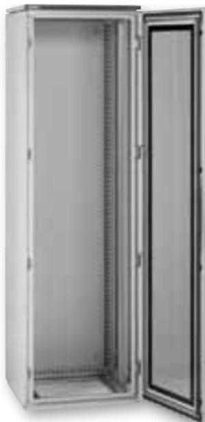
**Figura2** – In figura è riportato il classico armadio rack 19”, che ha larghezza esterna 800mm, e una larghezza utile interna di circa 650mm.
